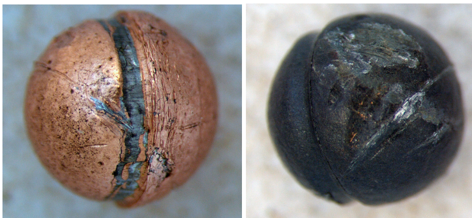
Рис. 1. Сліди переспорядження на кулях патронів калібру 4 мм Флобер
