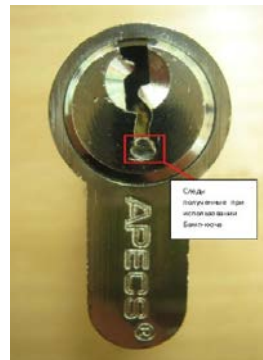
Рис. 2. Следы, полученные при использовании бамп-ключа
